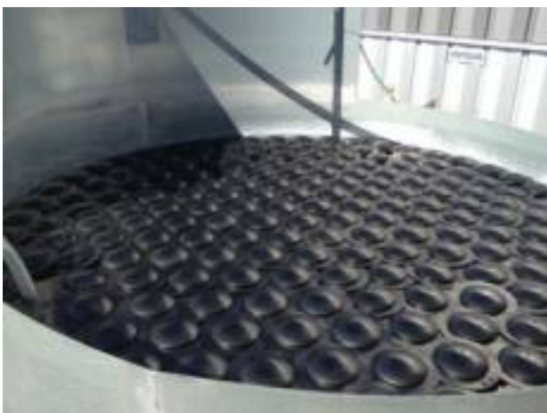
Les flotteurs biomimétiques empêchent l'évaporation des fluides toxiques. © Elbé Petro
